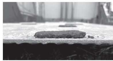
溶接による底上げ加工
